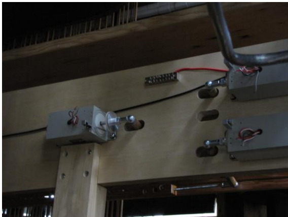
De laatste motoren op hun plaats in het orgel
