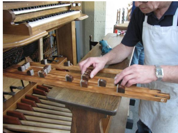
De combinatiepedalen sturen deze stangen aan
