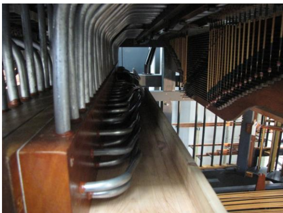
De binnenkant is klaar: pneumatiek en mechaniek
